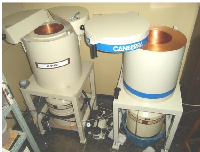
Figura 05. Blindagens da Canberra (Modelo 747) e da Ortec (HPLBS1) com o dewar do detector.
