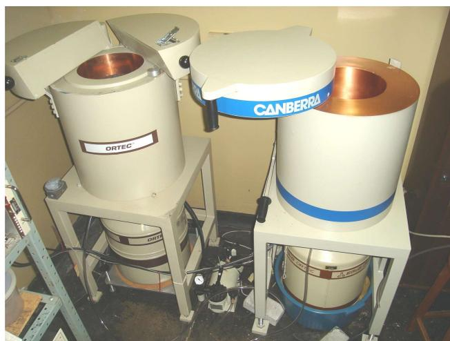
Figura 05. Blindagens da Canberra (Modelo 747) e da Ortec (HPLBS1) com o dewar do detector.
