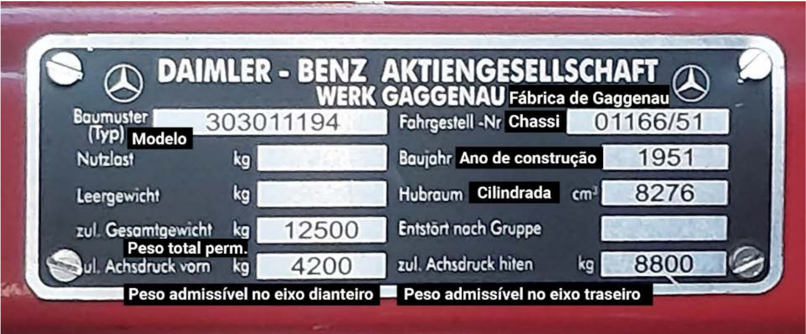
Figura 17 - Foto da plaqueta de identificação do caminhão dos bombeiros
