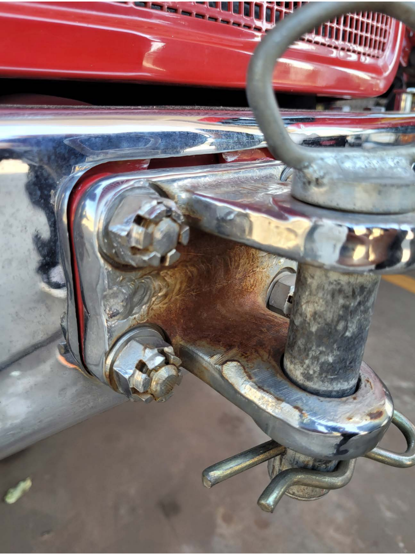
Figura 55 - Oxidação de Peças
