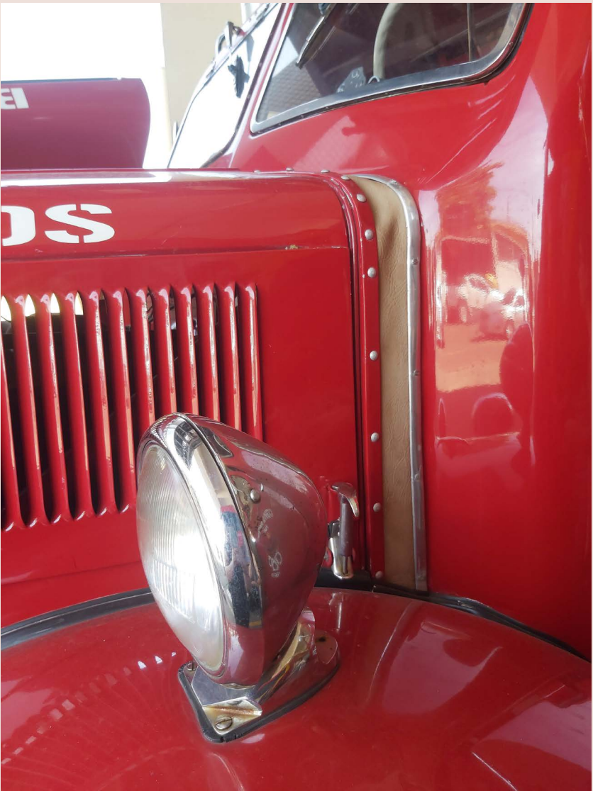
Figura 32 – Foto da união da cabine com o motor através da fita de couro
