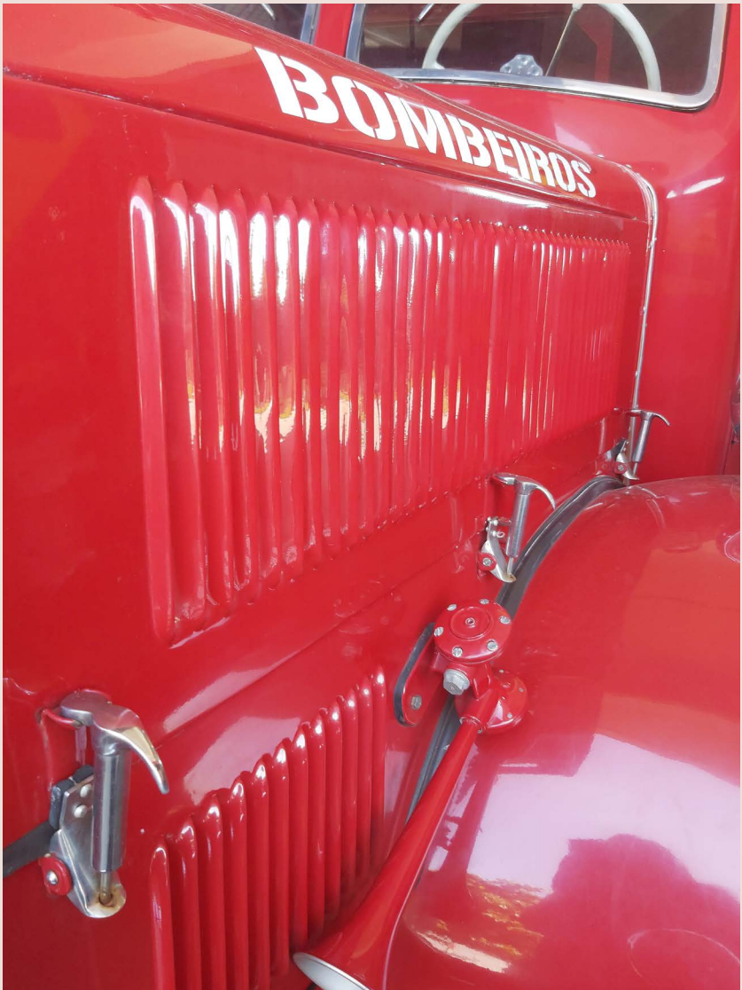
Figura 31 – Aletas na lateral do cofre do motor e mecanismos de fechamento do capô
