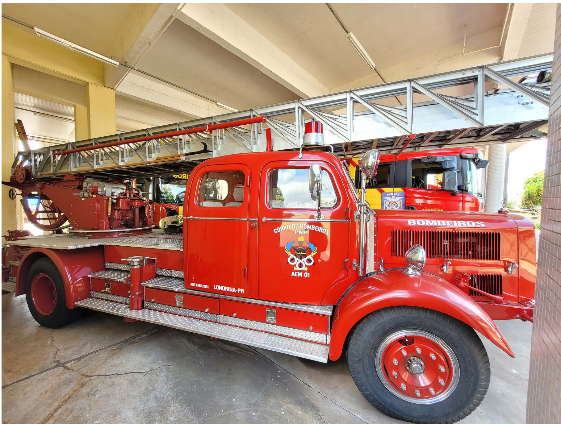
Figura 29 – Foto lateral do caminhão: escada Magirus, cabine e cofre do motor
