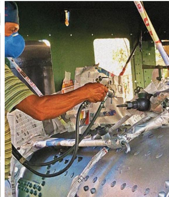
Como procedimento final desta etapa, ficou prevista a necessidade de realizar alguns procedimentos finais de pintura somente após o transporte até o MHL, devido a possibilidade de pequenas avarias na pintura durante a utilização de guindastes. A pintura de cores de contraste das rodas e limpa trilhos foi programada para ser utilizada somente após o posicionamento final do conjunto no MHL.
