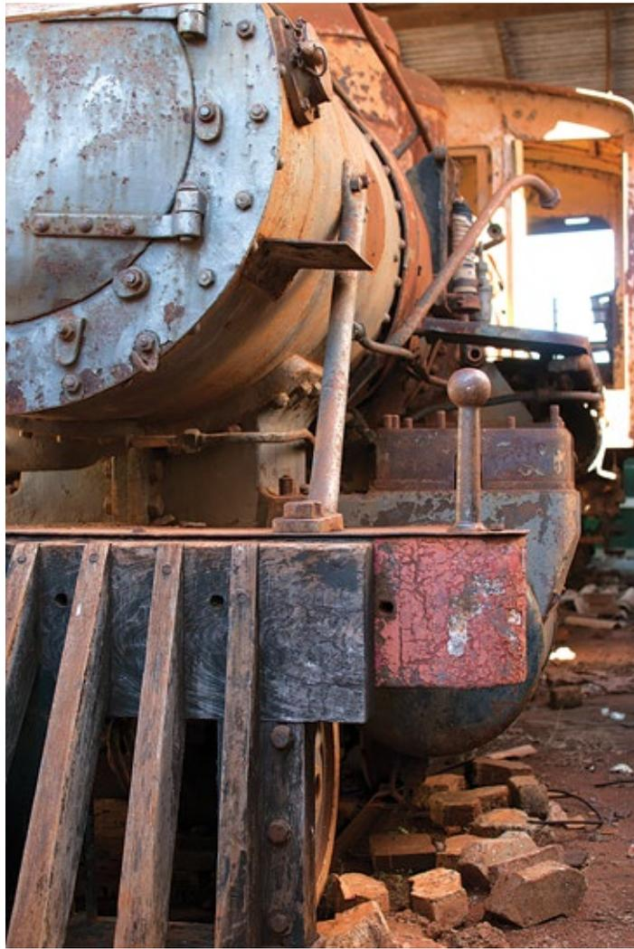
de refazer a chaminé da caixa de fumaça e o isolamento da caldeira com lâ de rocha, trocar as tubulações e limpar as grelhas e cinzeiros. Além disso, adequar as peças existentes no mercado para fins de restauro sem interferir na originalidade do equipamento. Os aparelhos de segurança, isto é, manômetro, injetores, válvulas e reguladores foram submetidos a teste de pressão em bancada com ar comprimido.
