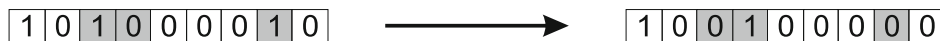
Figura 32 – Exemplo de mutação onde uma string binária tem três bits invertidos aleatoriamente. Extraído de Eiben e Smith [11].
