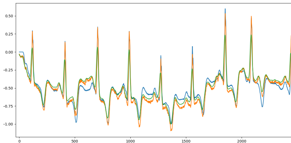
Figura 16 – Exemplo de resultado de filtragem com atraso removido. Filtro utilizado: Butterworth de 7ª ordem. Em azul: sinal original. Em laranja: sinal com ruídos artificiais. Em verde: sinal filtrado
