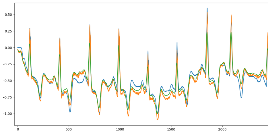
Figura 13 – Exemplo de resultado de filtragem com atraso removido. Filtro utilizado: Butterworth de 7ª ordem. Em azul: sinal original. Em laranja: sinal com ruídos artificiais. Em verde: sinal filtrado
